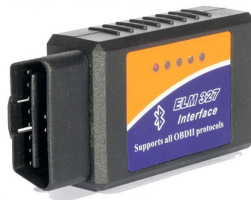
Figure – un port OBD2 et un module ELM327
