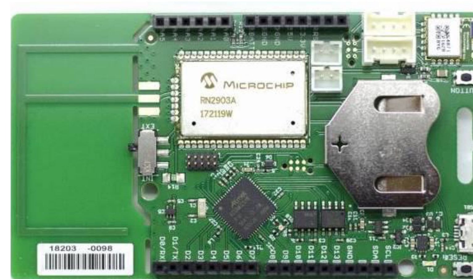
Gateway - BLE and LoRa
