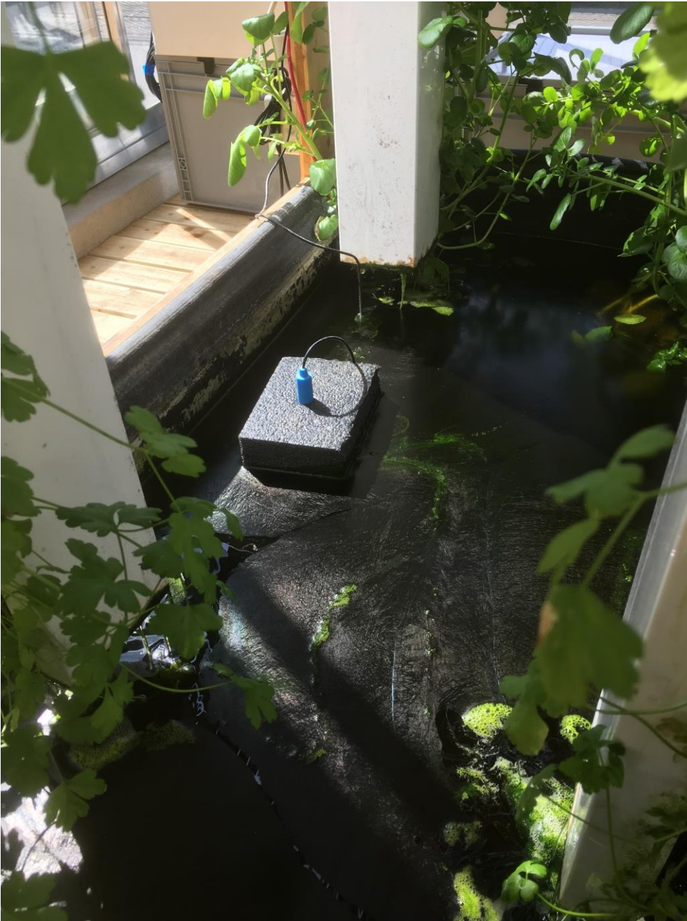
Figure 7 : Photo du porte capteur
