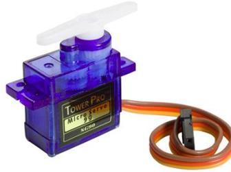
Ce petit moteur de type servo permet une rotation à 180°. Il fonctionne très bien avec les cartes Arduino grâce à sa compatibilité 5v. Nous nous servirons de ce moteur pour faire monter et descendre notre cible.
