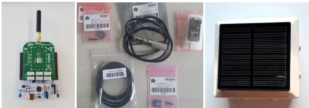
Carte nucleo L073RZ et son module LoRa + Capteurs + Panneau solaire
