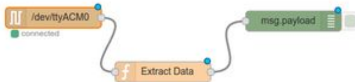
Exemple de l'interface de Node-RED Ici, on récupère les données en provenance du port serial "/dev/ttyACM0", elles passent dans la fonction "Extract Data", puis on les affiche.
